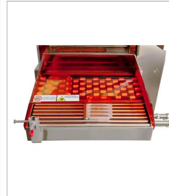
**Serializzatore vaschette** Dispositivo applicato al termine della termosigillatrice utilizzato per allineare in maniera automatica su un'unica fila le vaschette. Ideale per l'integrazione con etichettatrici automatiche o peso-prezzatrici.
