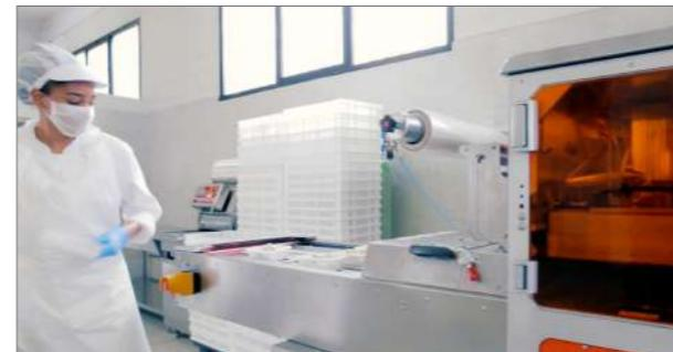
**Confezionare in ATM** Confezionare in ATM (atmosfera modificata) significa mantenere le caratteristiche proprie dell'alimento fresco confezionato il più a lungo possibile, senza utilizzare conservanti chimici. Il principio su cui essa si basa prevede la sostituzione dell'aria presente nell'involucro con una miscela prestabilita di gas alimentare. In questo modo la qualità del cibo è tutelata e la shelf life è prolungata. Perfetta per pasta fresca, prodotti precotti o crudi (pesce e carne).
