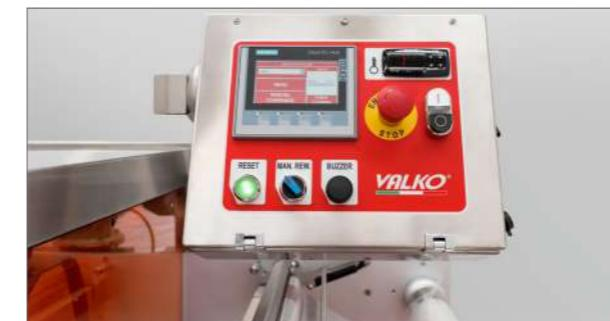
**Facilità di utilizzo** Il touch-screen Siemens Simatic HMI, forte della propria semplicità e intuitività, risulta facilmente consultabile durante l'intero ciclo di confezionamento. Permette inoltre di modificare, a seconda delle vaschette utilizzate, numerosi parametri di confezionamento come il tempo di saldatura, la percentuale di gas e la percentuale di vuoto.
