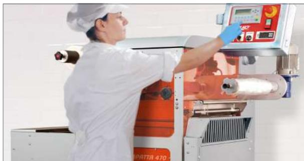
**Confezionare in ATM** Confezionare in ATM (atmosfera modificata) significa mantenere le caratteristiche proprie dell'alimento fresco confezionato il più a lungo possibile, senza utilizzare conservanti chimici. Il principio su cui essa si basa prevede la sostituzione dell'aria presente nell'involucro con una miscela prestabilita di gas. In questo modo la qualità del cibo è tutelata e la shelf life è prolungata. Perfetta per pasta fresca, prodotti precotti o crudi (pesce e carne).
