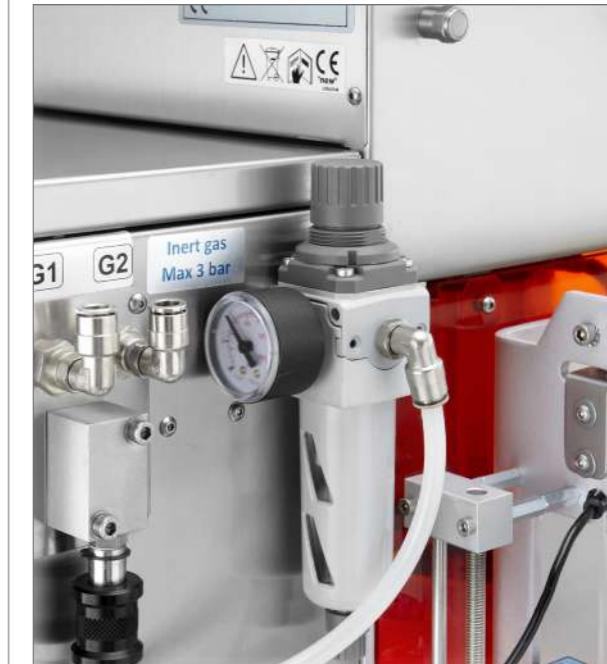
**Doppio ingresso gas** Possibilità di lavorare con 2 miscele di gas diverse e selezionare direttamente dal pannello operatore quella da utilizzare.
