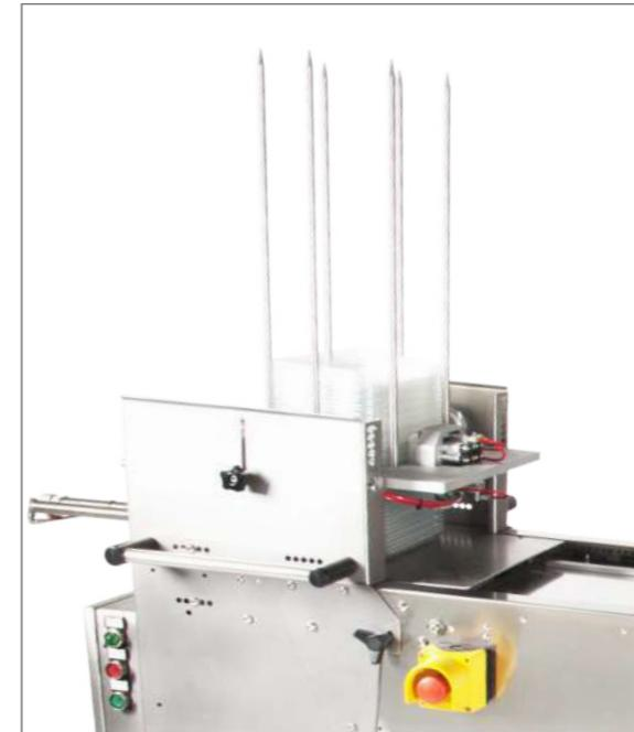
**Disimpilatore automatico per vaschette** Disimpilatore automatico per vaschette integrato che si interfaccia direttamente al PLC della termosigillatrice automatica in LINEA ed effettua anche il controllo di presenza vaschette.
