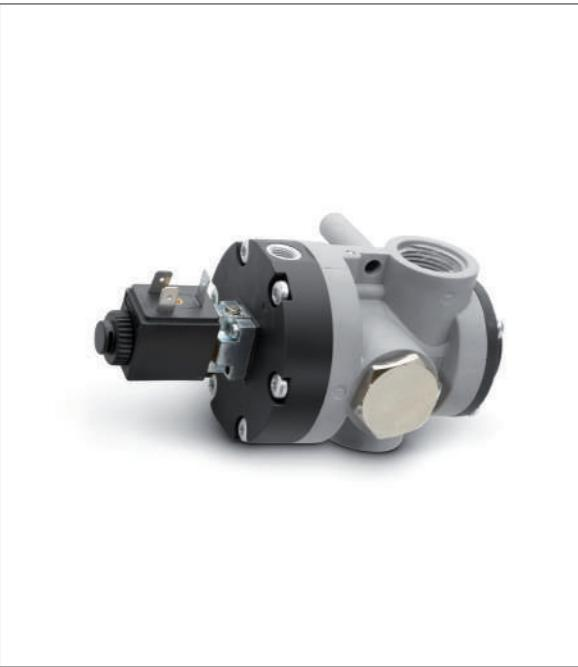
**Valvola di blocco** per miscele ad alto contenuto di ossigeno (O<sub>2</sub> > 21%): le macchine sono dotate di valvola di sicurezza per lavorare con miscele di gas ad alto contenuto di ossigeno, utilizzate per il confezionamento delle carni rosse.
